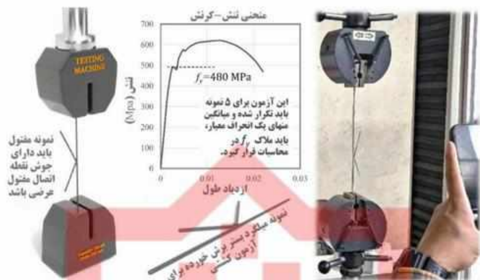
شکل پ-۴-۱ نحوه انجام آزمون کششی بر روی نمونه میلگرد بستری.
